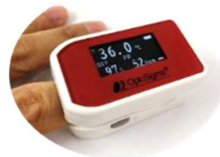
「パルスオキシメータ」と 「非接触皮膚赤外線体温計」の 2つの機能を持った管理医療機器
