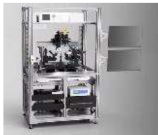
ナノオーダーの調芯精度を持つ 量子チップなどの調芯・加工装置
