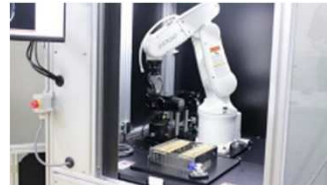
ロボティクスとAI画像解析を統合した 光学素子の自動欠陥検査装置
